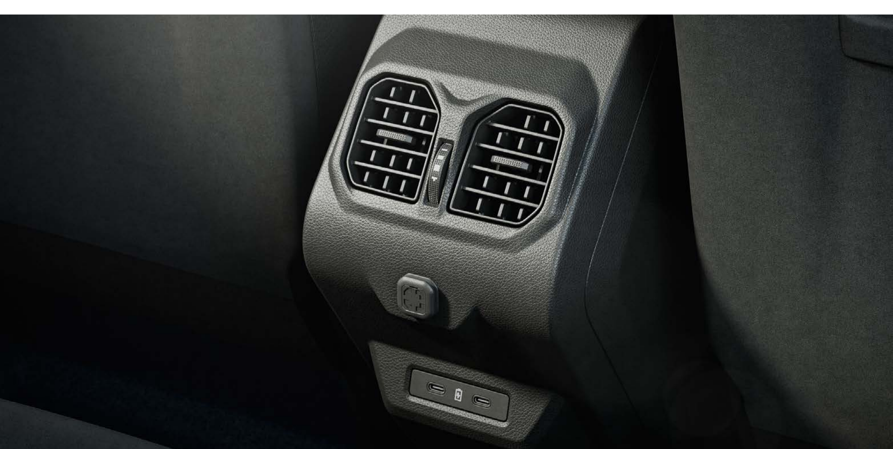
Výduchy klimatizácie vzadu
